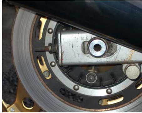
Serieproduksjon over et visst press: Moderne kassebaksving, men simpel kjedestrammer.
