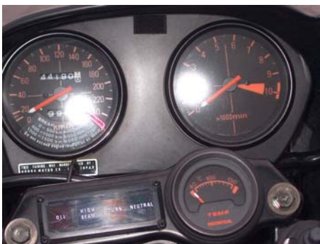
Komplett, men uten noe spesielt særpreget: instrumentene ligger på vanlig Honda-nivå. Fra 1982 fantes det et oljetermometer. Tallene det viste gav ikke ubetinget tillit til maskinen.
