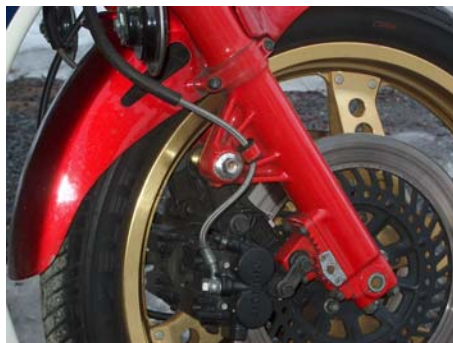
Fintrimming: Blant de få iøynefallende forandringer på 1982-modellen var stålomspunnede bremseledninger.
