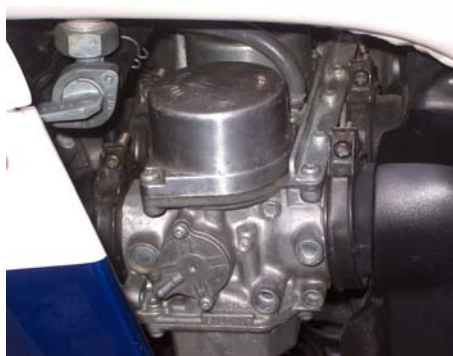
Uten pustebesvær: fire Keihin 33 mm liketrykk-forgassere
