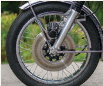
Fordekk i dimensjon 3.25 x 19" og bremseskive med diameter på 296 millimeter.
