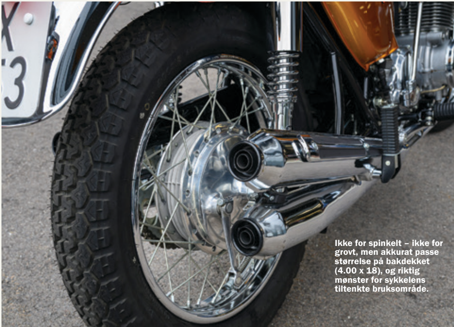
Svingarm og to støtdempere tar hånd om fjæringen bak. Fjærforspenet må muligens opp ved kjøring med passasjer?
