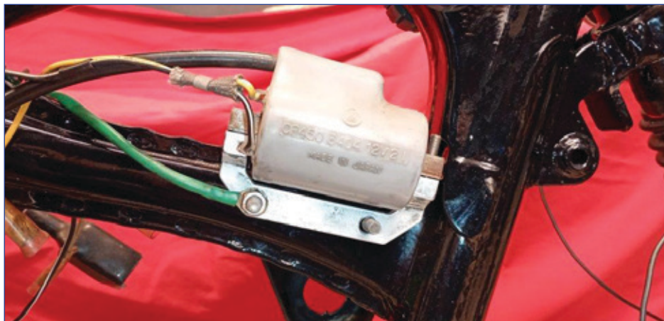
Ledningsnett jording til svak kontakt ved coil- brakett CB450, pga. lakkert ramme og ikke gjenger i ramme.
