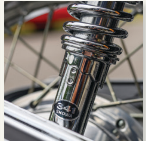
Svingarm og to støtdempere tar hånd om fjæringen bak. Fjærforspenet må muligens opp ved kjøring med passasjer?
