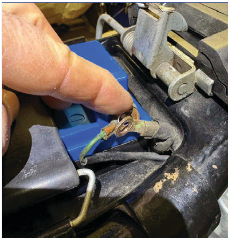
Jording ledningsnett på eldre CB450 går direkte til batteriets minuspol, god jording, men bedre til ramme.
